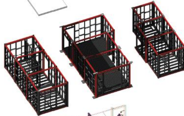
Module Steel Frame
